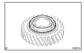
12. REMOVE 1ST GEAR NEEDLE ROLLER BEARING
