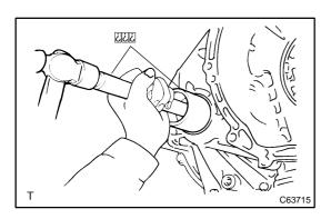
9. INSTALL TRANSAXLE HOUSING OIL SEAL(RH)
