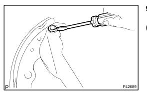
9. REMOVE REAR BRAKE PARKING BRAKE SHOE LEVER SUB-ASSY
